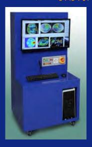
本計測装置には、遅延信号発生装置、制御用・演算用パソコン、モニタ、キーボード、マウス、無停電電源装置、制御盤、専用ディレイパルス発生装置が納められています。専用の制御・解析ソフト『FtrLFV』により、粒子画像の撮影コントロール、独自開発のPIV解析エンジンを利用した高速演算、PIVデータ解析作業などが最適の仕様で構成されています。
