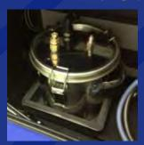
気流計測に最適なシーディングを供給する オイルミスト発生装置です。
