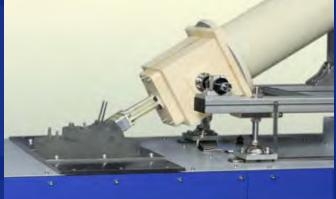
可動と交換機構を有する助走部は、インマニ側への流 体と整流すると共に、インマニポートの長さ、吸口の 形状や角度に合わせて様々なセッティングに柔軟に対 応します。
